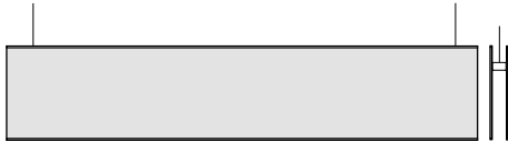
skwizmi 210 w 1000 x h 215 x d 40mm w 39,37 x h 8,46 x d 1,57"
