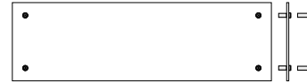
kit 108 V (kit B 30 / kit B 50) w 1000 x h 300 x d 8mm w 39,37 x h 11,8 x d 0,31"
